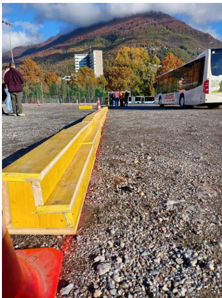
A sinistra bordura tipo in legno h = 22 cm / A destra foto con drone del campo prova
