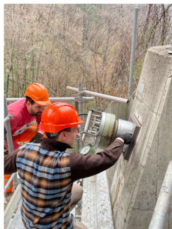
Prove di tesatura e stacco degli ancoraggi della parete di sostegno del viadotto Pianturino e scopertura di uno degli ancoraggi del viadotto Sasselli per l'esecuzione delle prove di stacco
