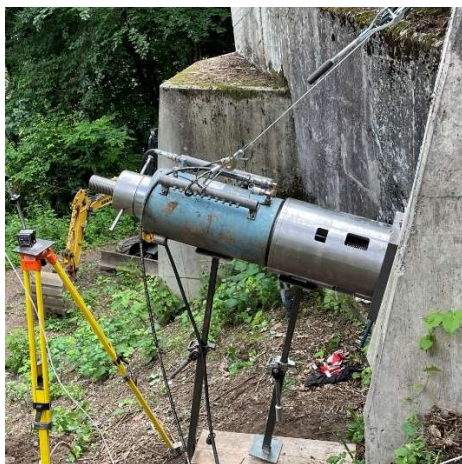
Prove di tesatura e stacco degli ancoraggi della parete di sostegno del viadotto Pianturino e scopertura di uno degli ancoraggi del viadotto Sasselli per l'esecuzione delle prove di stacco
