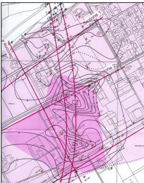
Bild 3: Setzungsempfindliche Böden südlich der Kantonsstrasse (organische Lehme) - Kumulierte Dicke in den oberen 35 m
